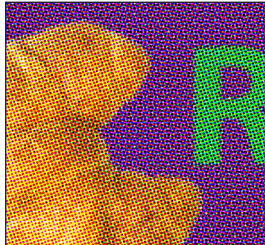
Motiv aus CMYK im Siebdruckverfahren
