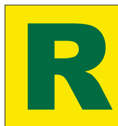
Schrift wurde überdruckt, d.h.: Das Blau der Schrift wurde über das Gelb des Hintergrunds gelegt und verschmischt sich so zu Grün
